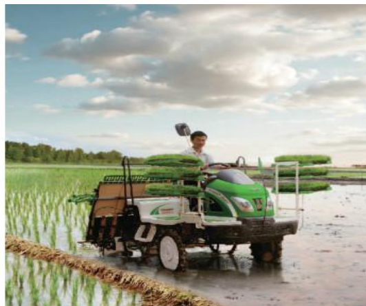
تصویر 6-6-الف) دستگاه نشاکار برنج
