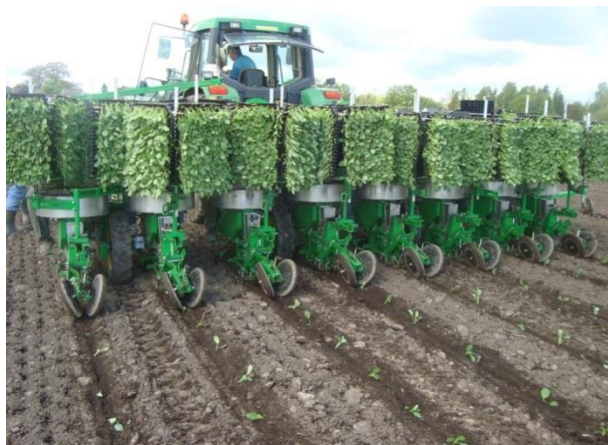
تصویر 6-6-ب) دستگاه نشاکار محصولات زراعی و صیفی جات
