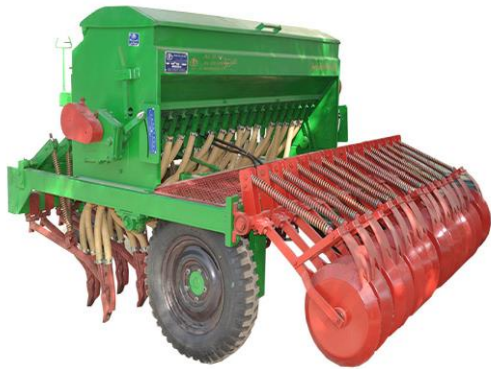
تصویر 5-6-ب) بذرکار خطی کار دیم (با عمیق کار)
