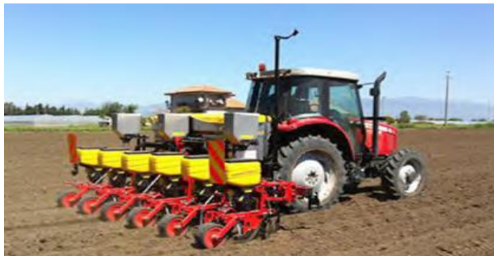
تصویر 1-6 دستگاه ردیف‌کار بذر
