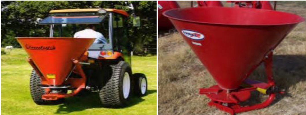
تصویر 6-4- کود پاش‌هایی که به عنوان بذرپاش نیز مورد استفاده قرار می‌گیرند.
