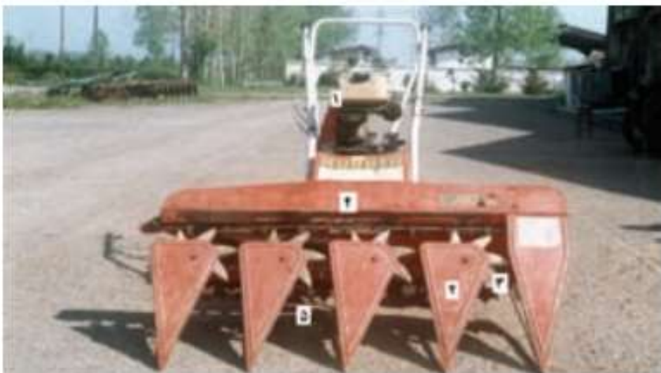
۱- موتور ۲- دماغه ۳- جرخ ستاره‌ای ۴- انگشتی‌ها و زنجیر ۵- شانه برش
