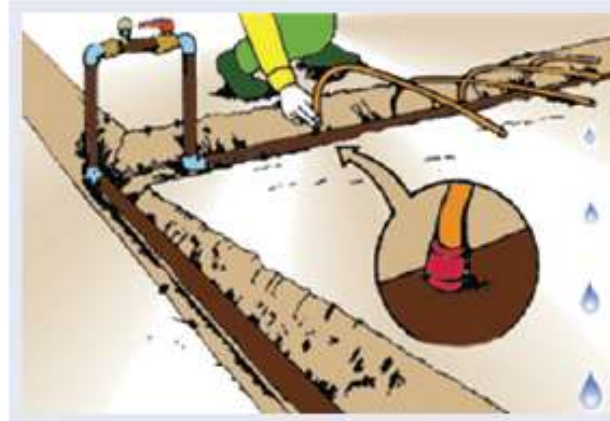
مراحل حفاری، کارگذاری و نصب لوله‌های اصلی، نیمه اصلی در آبیاری قطره‌ای
