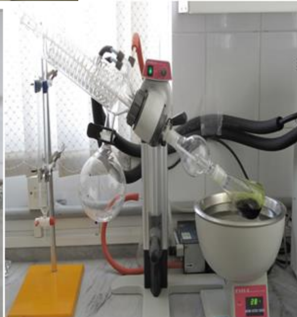
تغلیظ عصاره های گیاهی با استفاده از دستگاه روتاری ————— نحوه صاف کردن عصاره های گیاهی با استفاده از قیف و کاغذ
