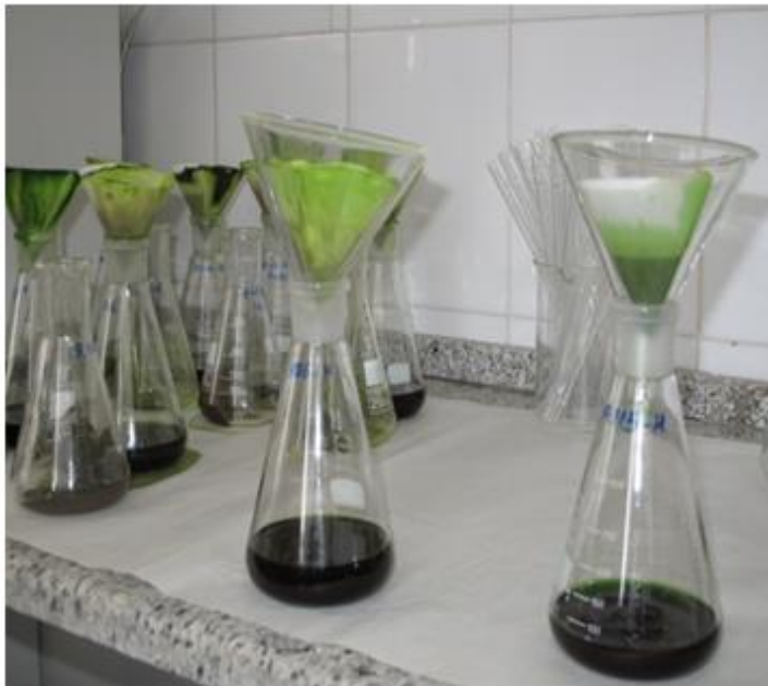
تغلیظ عصاره های گیاهی با استفاده از دستگاه روتاری ————— نحوه صاف کردن عصاره های گیاهی با استفاده از قیف و کاغذ
