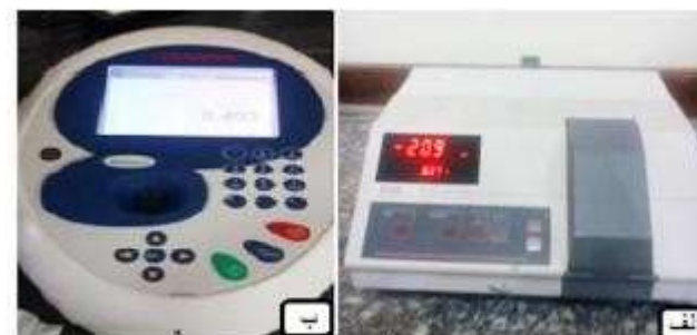
شکل ۲-۸- (الف) امپکتروفتومتر تک پروبی ساخت شرکت Jenway مدل ۶۱-۵ (ب) امپکتروفتومتر دو پروبی مرنی- مایو اینفلز توسط دستگاه
