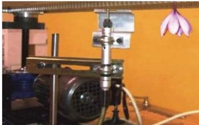
شکل ۲- جدا کردن کلاله از گل زعفران دستی (بالا)، دستگاه جداکننده کلاله (پایین)
