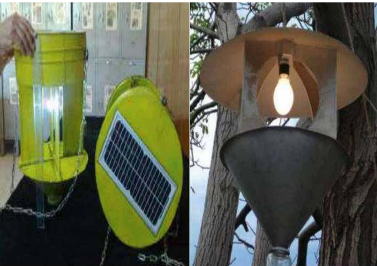
تله نوری شارژ شونده با نور خورشید (سمت چپ) و تله نوری با جریان برق (سمت راست)
