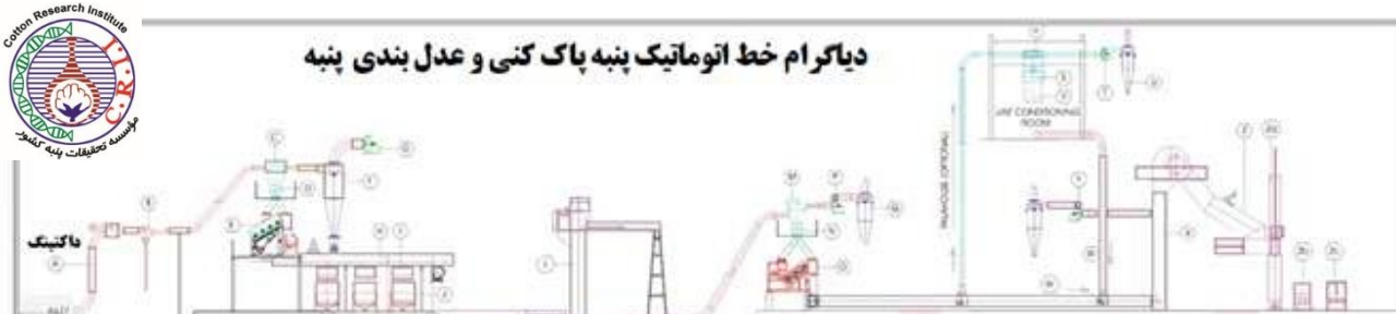
بخش انتقال الیاف و عدل بندی بخش تهویه الیاف پنبه بخش تمیز سازی و الیاف پنبه فیدر و جداسازی الیاف پنبه ساکنن و بیش تمیز کنی پنبه
